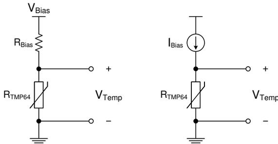
$$V_{Temp} = \frac{V_{Bias} * R_{TMP64}}{R_{Bias} + R_{TMP64}}$$
