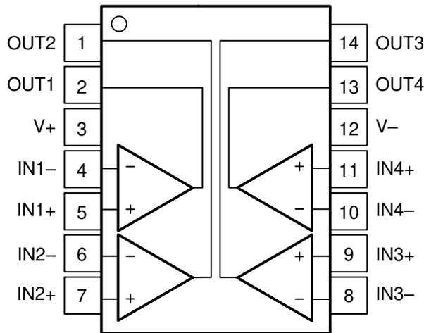
**D, PW, DYY Package, 14-Pin SOIC, TSSOP, SOT-23,
