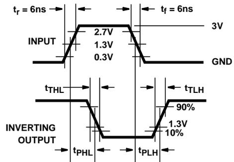
**FIGURE 3. TRANSITION TIMES AND PROPAGATION-DELAY TIMES, COMBINATION LOGIC**
