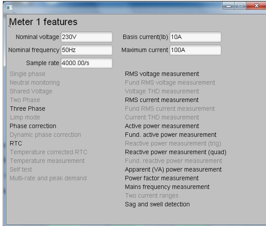
**Figure 36. Meter Features Window**
