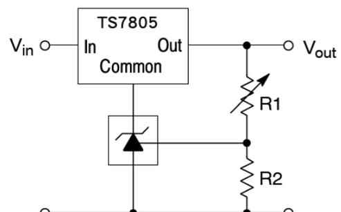
$$V_{out} = \left(1 + \frac{R1}{R2}\right) V_{ref}$$
