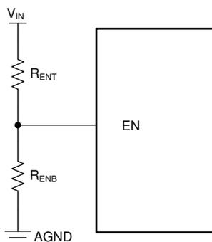
**Figure 8-1. V<sub>IN</sub> UVLO Using the EN pin**
