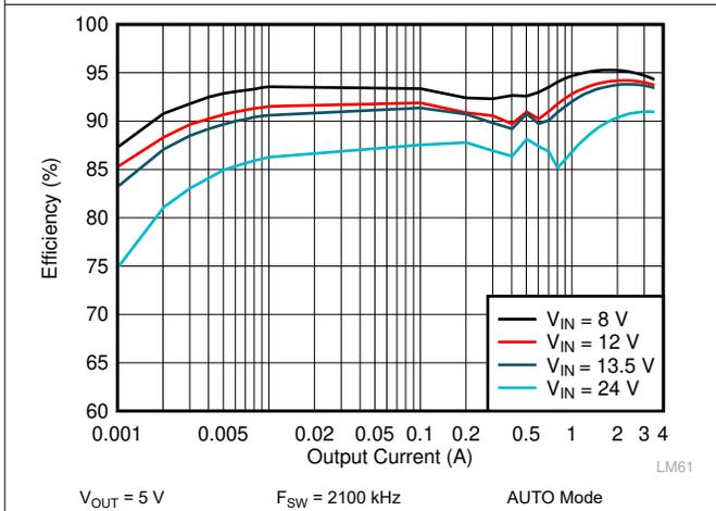
**Figure 9-7. LM62435-Q1 Efficiency**
