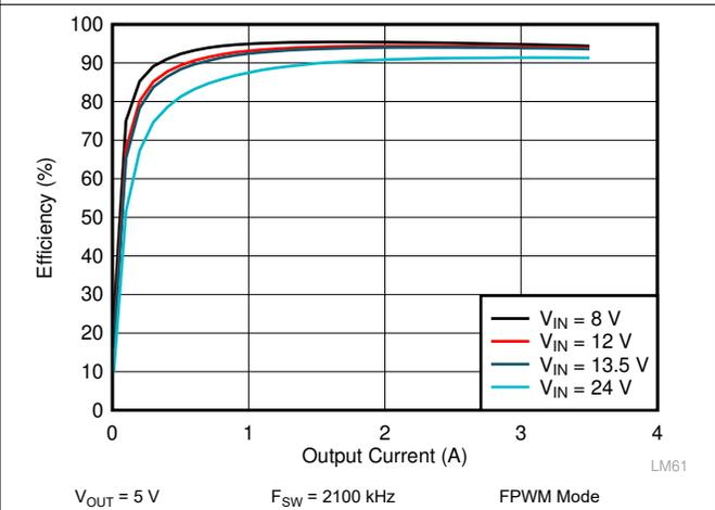
**Figure 9-8. LM62435-Q1 Efficiency**
