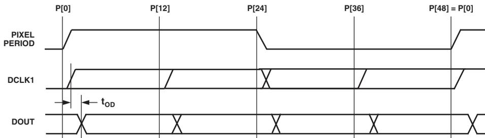
1. DCLK1 PHASE IS ADJUSTED BY SETTING THE DCLKPHASE REGISTER (ADDR 0x02).
